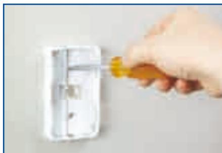
2) 将电路板连接到壁面安装板。
